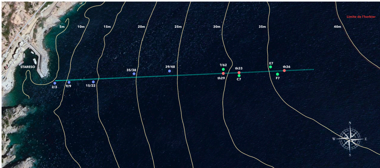
Figure 22 : Représentation du transect bathymétrique et de la position des stations échantillonnées. La droite turquoise représente le transect. Un point bleu représente une station commune en 1993, 2018 et 2019. Un point vert (resp. rouge) représente une station en 1993 (resp. 2018 et 2019). Les stations E7 et F7 ont été fusionnées (réalisation personnelle).
