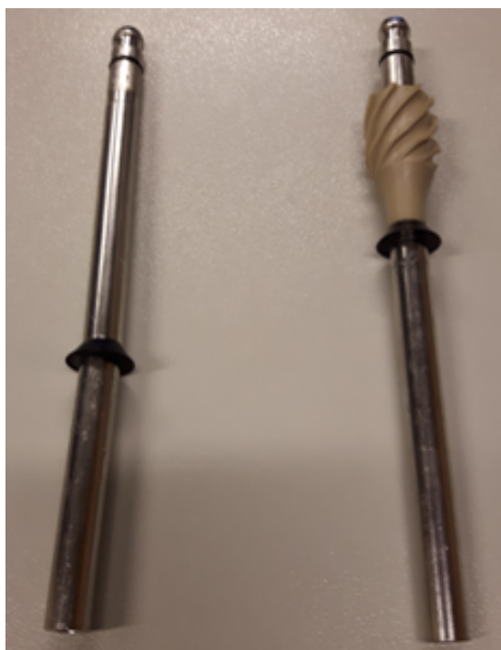
FIGURE 5.14 – Comparaison entre les canules à spirales et les ordinaires
