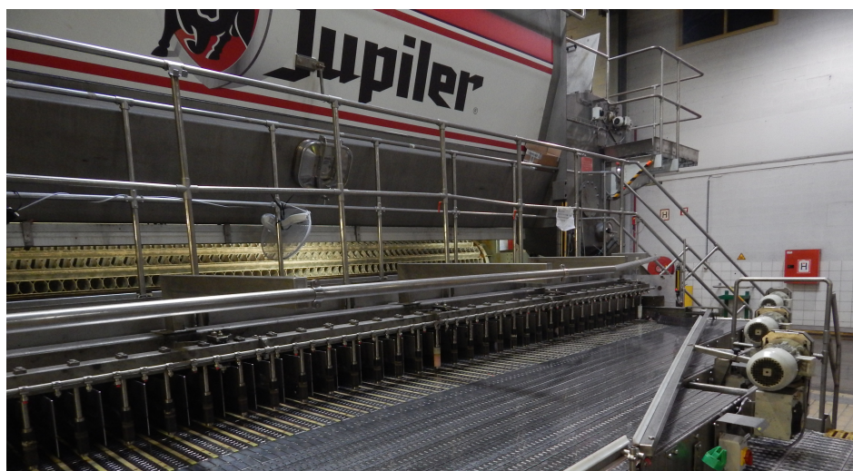
FIGURE 4.2 – Entrée de la laveuse bouteilles du groupe 1 - ABI Jupille
