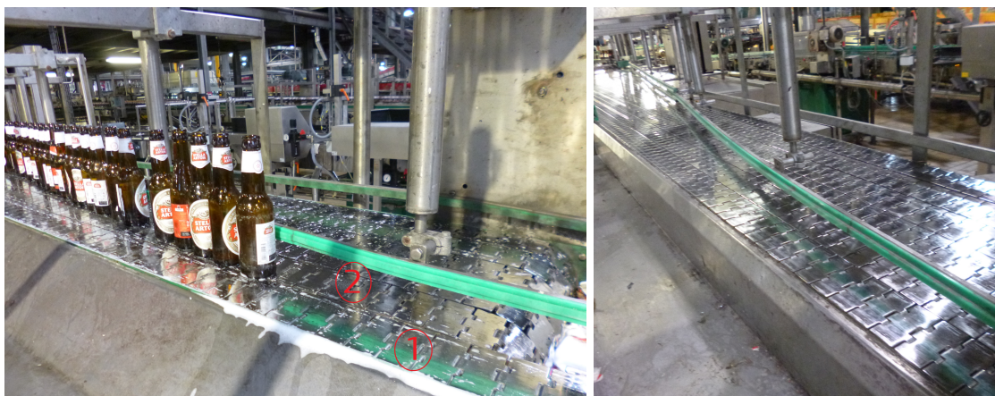
FIGURE 5.6 – Aligner en entrée du système de détection et d'éjection Heuft Spectrum sur le groupe 1 - ABI Jupille
