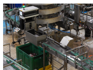
FIGURE 5.4 – Section d'inspection et d'éjection des trieuses Heuft Spectrum - ABI Jupille
