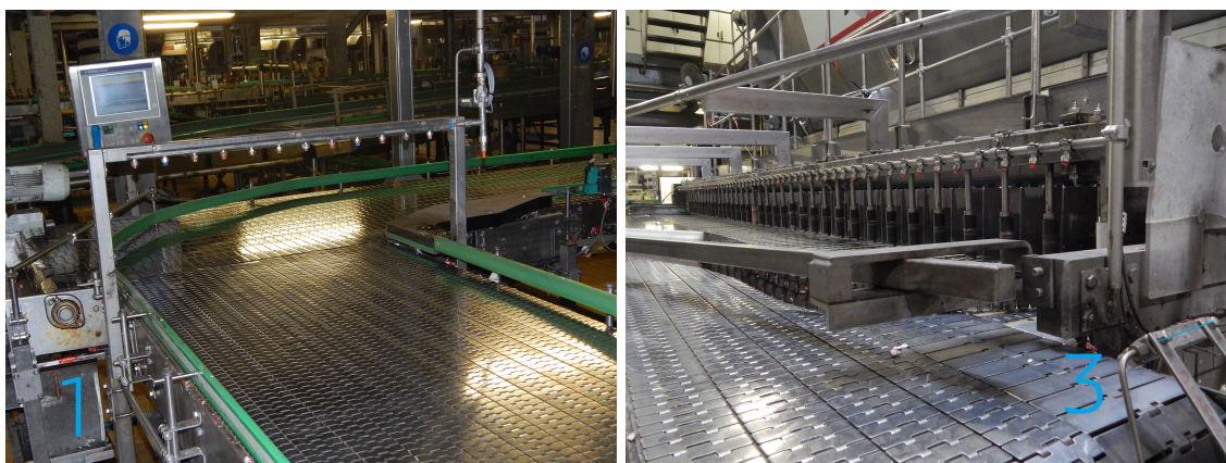
FIGURE 6.5 – Rampes de lubrification en entrée de la laveuse bouteilles du groupe 1 - ABI Jupille
