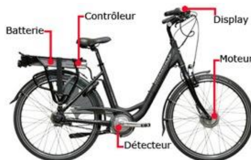
Figure 11. Technologie d'un vélo électrique (km10.be., s.d.)
