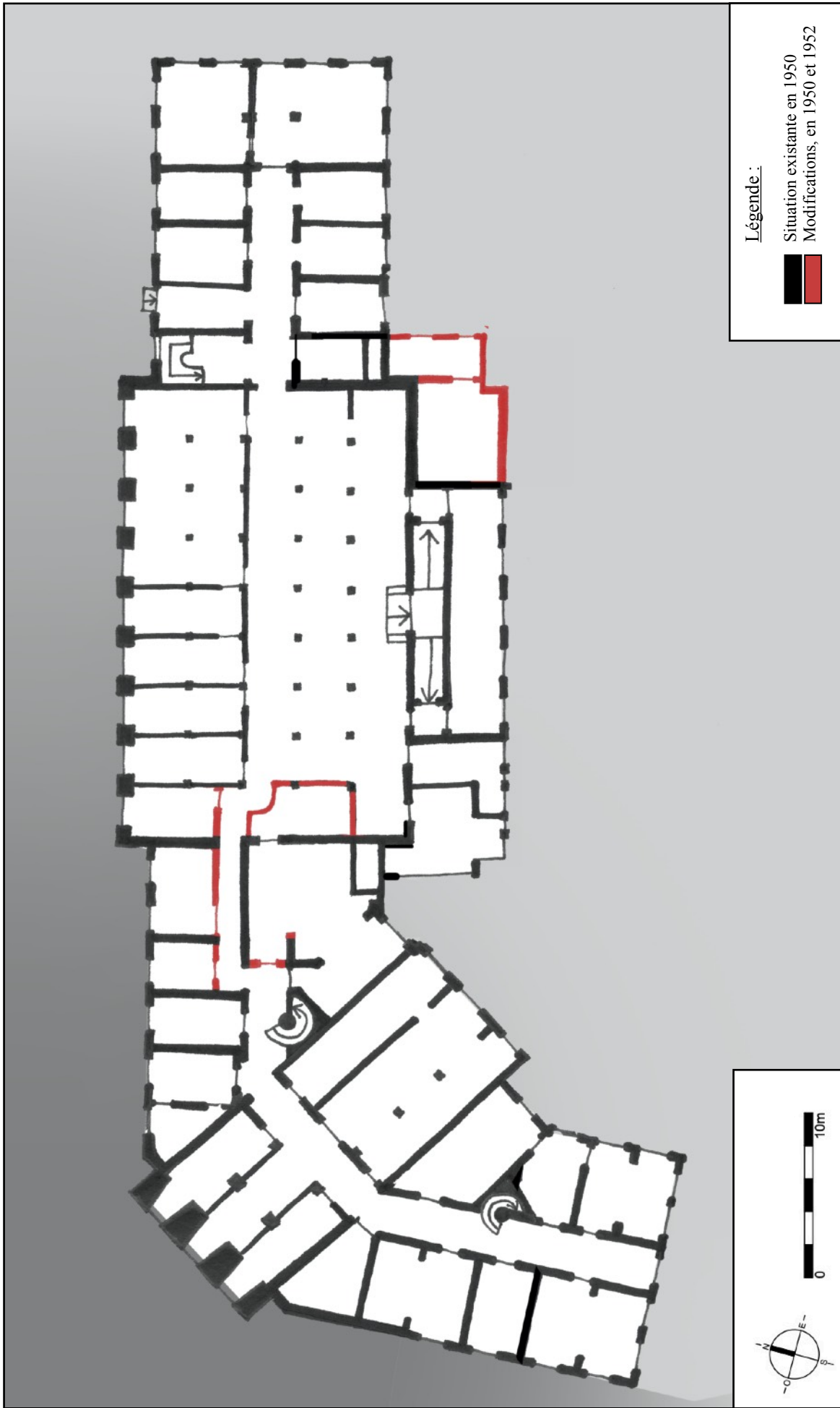
Ann. 22. : Schéma des transformations effectuées au sous-sol de l'Institut pharmaceutique, entre 1950 et 1952.
