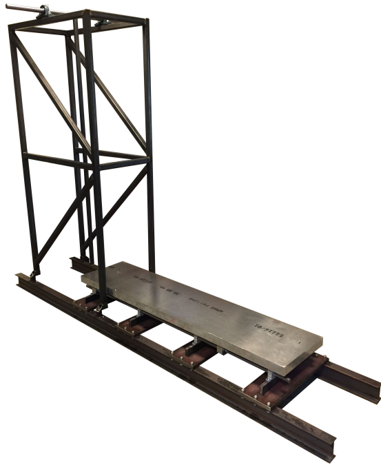
FIGURE 1 – Machine d'essais aux chocs construite
