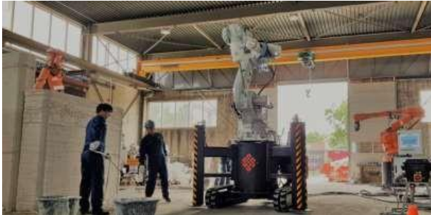
Figure 71 : CyBe, RC 3Dp, imprimante de construction à bras robotisé, Pays-Bas, 2018.
