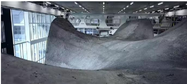
Figure 21 : ETH Zurich, Robotic Fabrication Lab, Prototype de construction à grande échelle du toit en coque NEST HiLo, 2017.
