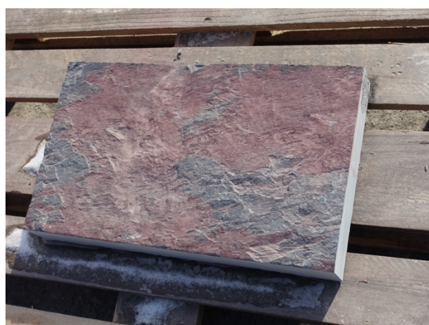
Figure 76: Pierre de schiste sciée pour en faire des dalles (Norbert Nelles, 2021).
