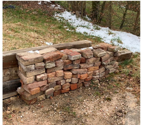
Figure 80: Morceaux de briques conservés sur le chantier pour de la réutilisation (Manon Vandersmissen, 2022).
