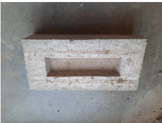
FIGURE 5.29 – Résultat de test de chute d'une brique de type R-C-V
