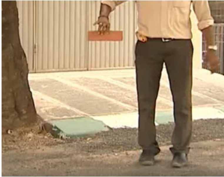
FIGURE 3.20 – Test de chute d’une brique sur site (hauteur de chute : 1 [m]) [64]
