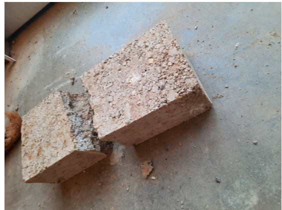
FIGURE 5.28 – Résultat de test de chute d'une brique de type R-C-IV
