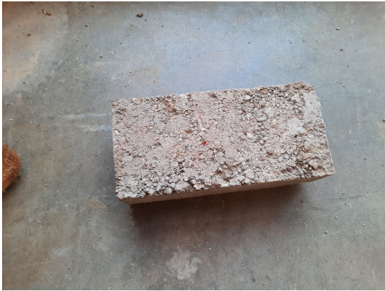
FIGURE 5.27 – Résultat de test de chute d'une brique de type R-C-III
