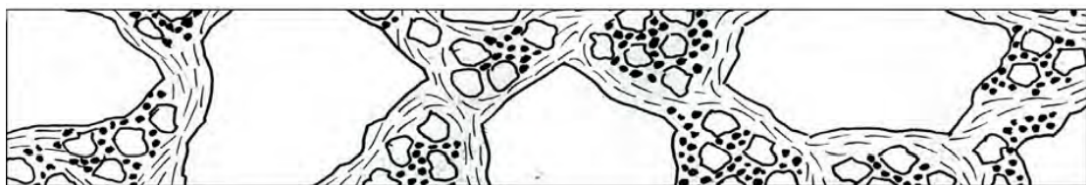
FIGURE 2.22 – Squelette d'une brique en terre crue comprimée [25]
