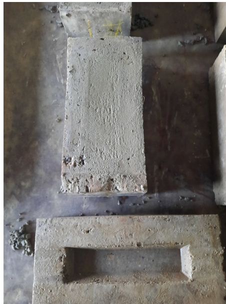
FIGURE 3.14 – Brique dont l'encoche est remplie de mortier normalisé
