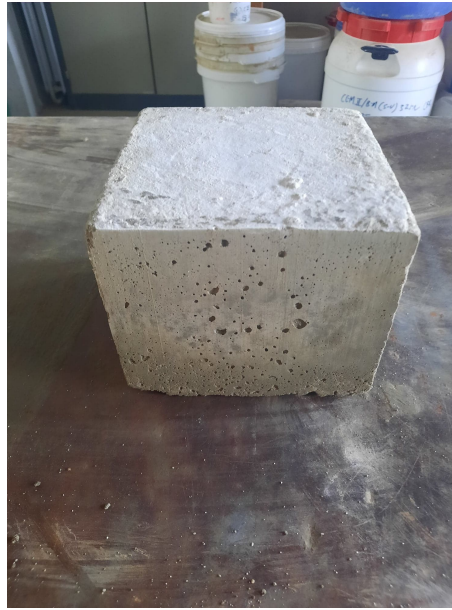
FIGURE 3.13 – Bloc de mortier normalisé
