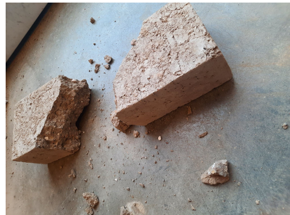
FIGURE 5.26 – Résultat de test de chute d'une brique de type R-C-II
