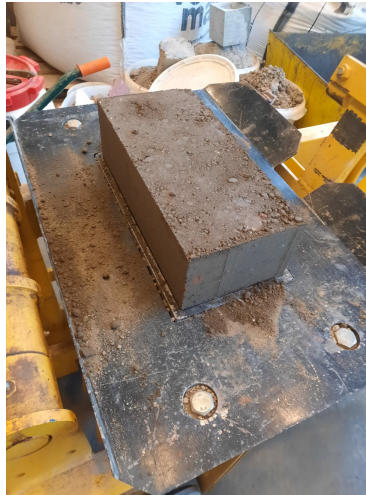
FIGURE 5.22 – Brique comprimée réalisée avec le mélange R-VIII
