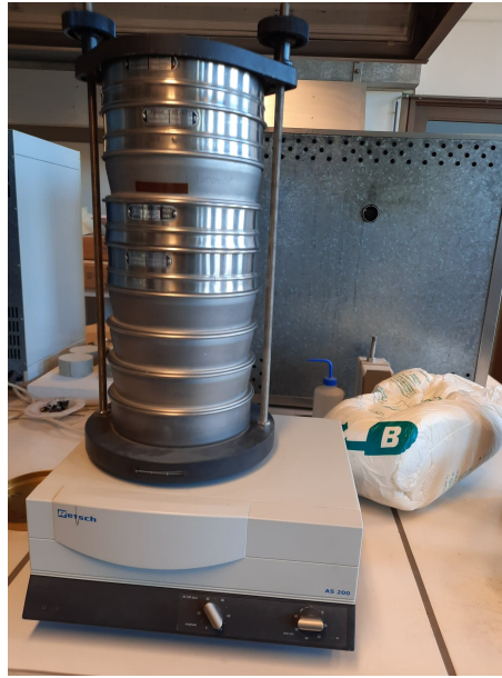
FIGURE 3.1 – Colonne de tamis sur la plateforme vibrante
