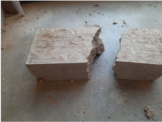
FIGURE 5.30 – Résultat de test de chute d'une brique de type R-E-VI
