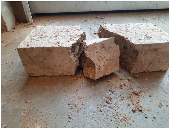
FIGURE 5.31 – Résultat de test de chute d'une brique de type R-E-VII
