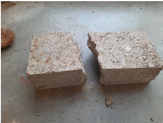
FIGURE 5.28 – Résultat de test de chute d'une brique de type R-C-IV
