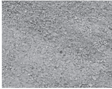
FIGURE 2.35 – Granulats fins recyclés produits à partir de déchets de brique et de béton [6]
