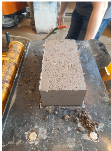
FIGURE 5.12 – Brique comprimée réalisée avec le mélange R-C-V
