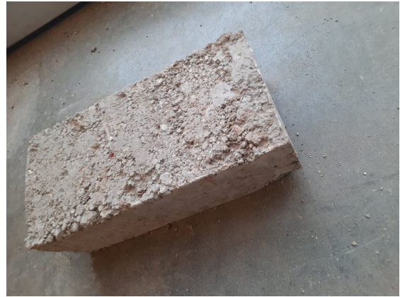
FIGURE 5.27 – Résultat de test de chute d'une brique de type R-C-III
