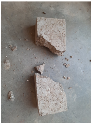
FIGURE 5.26 – Résultat de test de chute d'une brique de type R-C-II
