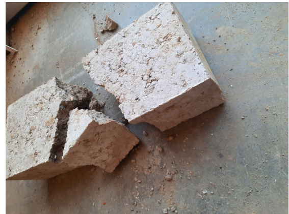
FIGURE 5.31 – Résultat de test de chute d'une brique de type R-E-VII
