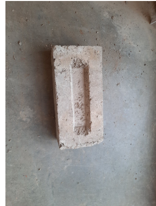
FIGURE 5.25 – Résultat de test de chute d'une brique de type REF-I
