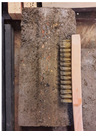
FIGURE 5.33 – Résultat du test d'abrasion sur la brique R-VIII-12
