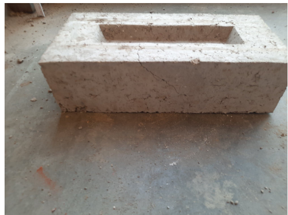
FIGURE 5.29 – Résultat de test de chute d'une brique de type R-C-V
