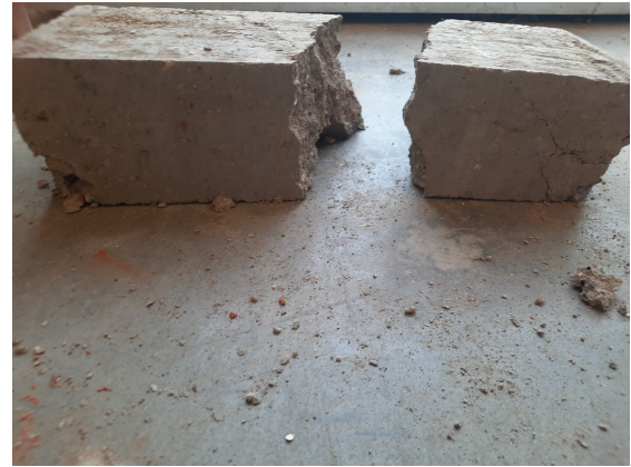
FIGURE 5.30 – Résultat de test de chute d'une brique de type R-E-VI
