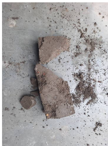
FIGURE 5.32 – Résultat de test de chute d'une brique de type R-VIII
