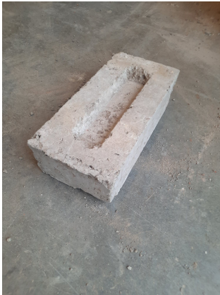
FIGURE 5.25 – Résultat de test de chute d'une brique de type REF-I
