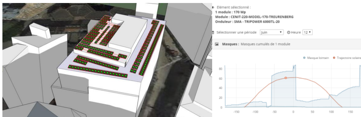
Figure 32: Modèle Sketchup de la toiture, et exemple de masque solaire d'un module sélectionné en bas de la façade est. Source : ISSOL, 2016c
