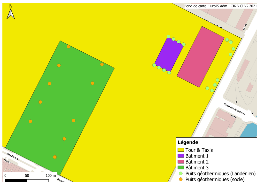
FIGURE 4.12 – Puits de pompage et de réinjection des 3 systèmes géothermiques ouverts à Tour & Taxis (CIRB-CIBG, 2021).
