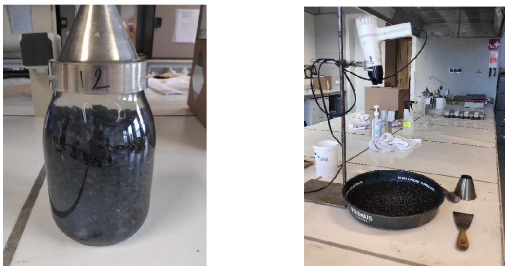
Figure 38 A gauche, pycnomètre vidé de tout air occlus, à droite, dispositif de séchage des sables
