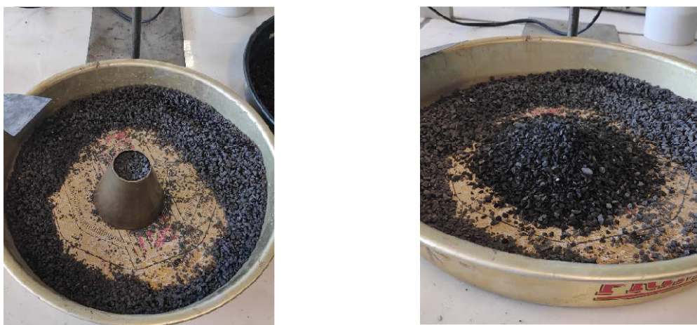
Figure 39 Retrait du moule tronconique indiquant l'état SSS du sable
