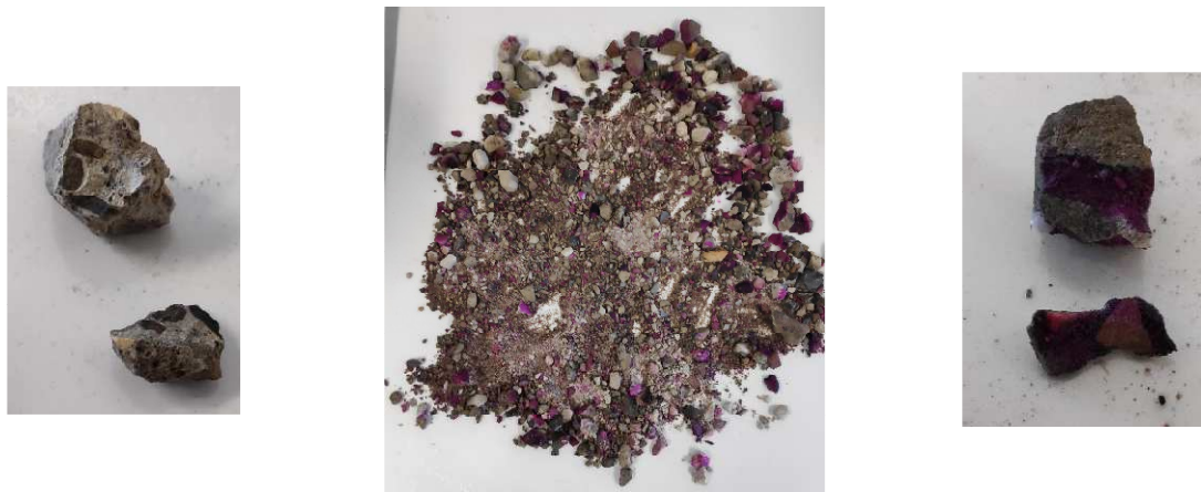
Figure 40 Essai à la phénolphthaléine des GBR Eloy avant carbonatation
