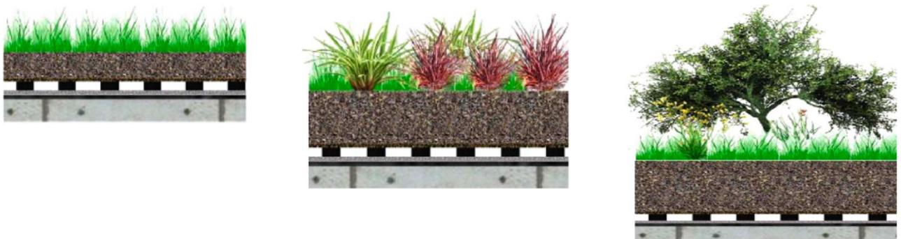
**Figure 20 - Schéma des trois types de toitures existants, toiture extensive (à gauche), toiture semi-intensive (au milieu) et toiture intensive (à droite), (Besir & Cuce, 2017)**
