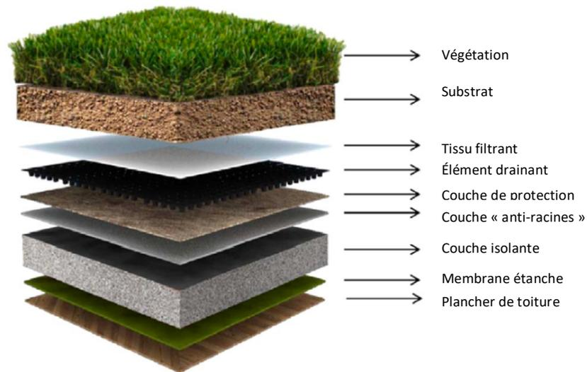
**Figure 19 - Schéma des différents composants des toitures terrasses, (Besir & Cuce, 2017)**
