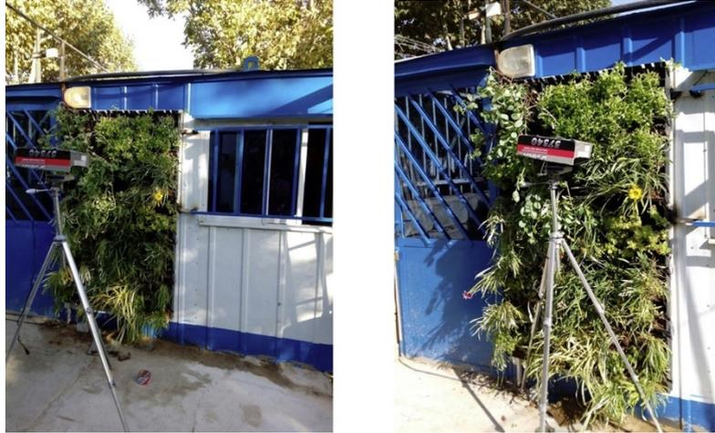
**Figure 6 - Chambre de test exposée au sud-ouest conçue pour analyser l'impact de la végétalisation d'une surface, (Shafiee et al., 2020)**
