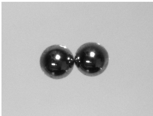
Figure 4.3 – Photographie, sous stéréozoom, d’un dimère assemblé par capillarité. Nous pouvons constater qu’il s’agit simplement d’un assemblage de deux sphères qui se touchent. Cette union simple permet d’obtenir une ligne de contact plus homogène et d’augmenter la reproductibilité.
