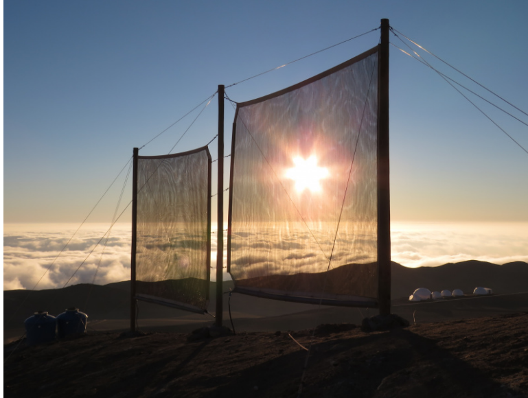
FIGURE 1.1 – Exemple de filet à nuages. L'eau se dépose sur le maillage, coule jusqu'au bas de la structure où elle est dirigée vers des réservoirs. Modèle commercialisé par la firme Low Tech.
