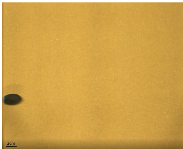
FIGURE 3.4 – Vue du haut sur l’arène en bois avec un robot possédant un support noir sur son dos permettant la détection et le suivi de celui-ci.
