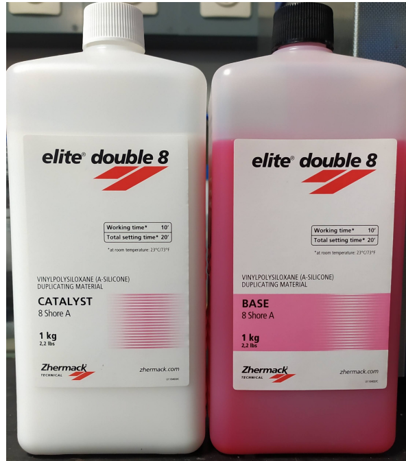
FIGURE 3.3 – Couple base/catalyseur possédant une dureté de 8 shore sur l'échelle A.
