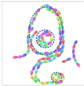
FIGURE 5.7 – Simulation de PAP elliptiques possédant un moment dipolaire élevé orienté selon leur grand axe. Simulation réalisée par N.Vanesse.
