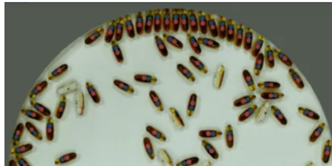
FIGURE 1.4 – Mouvement collectif de robots auto-propulsés par vibration dans une arène circulaire. Ces robots modifient leur direction et vitesse en fonction de leurs voisins conduisant à un regroupement au niveau des bords de l'arène [5].
