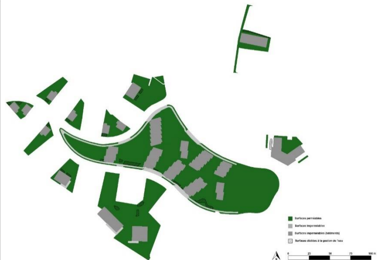
Figure n°68 Cartographie des surfaces perméables, imperméables et dédiées à la gestion des eaux pluviales pour le projet du quartier Homborchveld. Source : réalisation personnelle.
