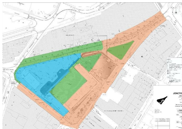
Figure n°25 Répartition de la surface totale du projet en 3 types de surfaces pour la gestion de l'eau. Source : réalisation personnelle sur base des données fournies par le bureau Greisch.
