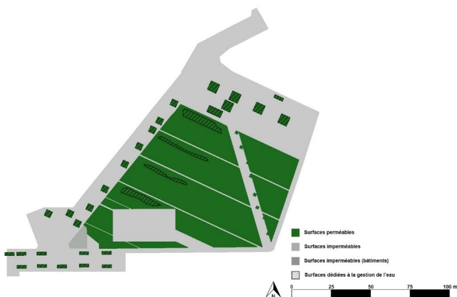
Figure n°78 Cartographie des surfaces perméables, imperméables et dédiées à la gestion des eaux pluviales pour le projet d'aménagement de la Place Marie Janson. Source : réalisation personnelle.
