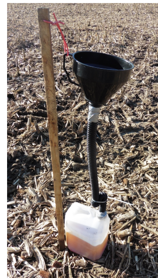
FIGURE 6.24 – Urinoir masculin auto-construit permettant de réaliser une lacto-fermentation des urines. La torsion dans le conduit d'urine fait office de siphon.
