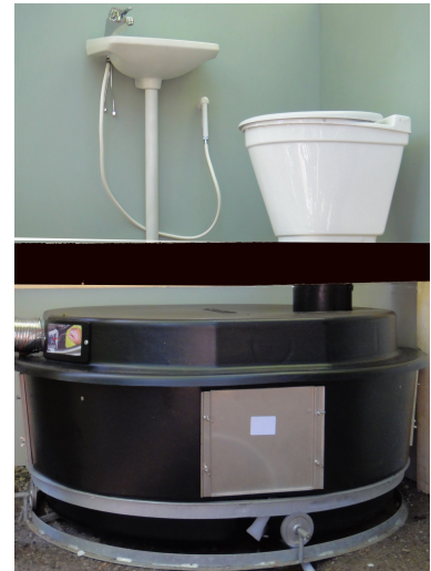
FIGURE 6.12 – Composteur rotatif manufacturé commercialisé par Ekolet. Le composteur pivote sur son axe quand une pile de matière suffisante s'est accumulée sous le tuyau de chute. (Source : Ekolet.)
