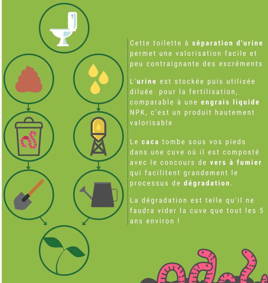
FIGURE A.8 – Plaquette explicative affichée dans la toilette : présentation du principe de la toilette
