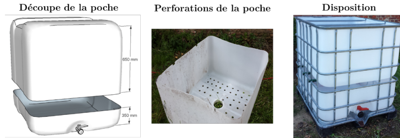
FIGURE 6.26 – Modification d'une cuve IBC en composteur.
