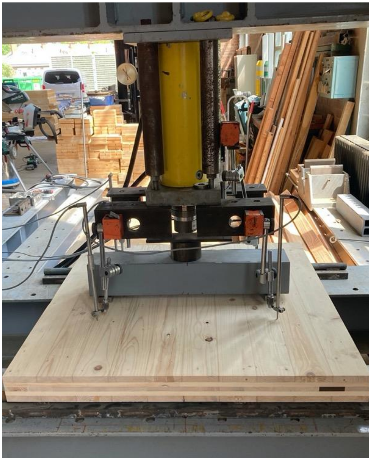
Annexe 5. Dispositif de l'essai en flexion simple du panneau CLT
