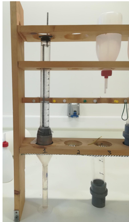
Figure 6 : Dispositif d'infiltrométrie avec l'infiltromètre minidisc.
