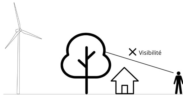
Figure 15 : Représentation schématique de la LOS étant interceptée par un objet entre un observateur et une éolienne.
