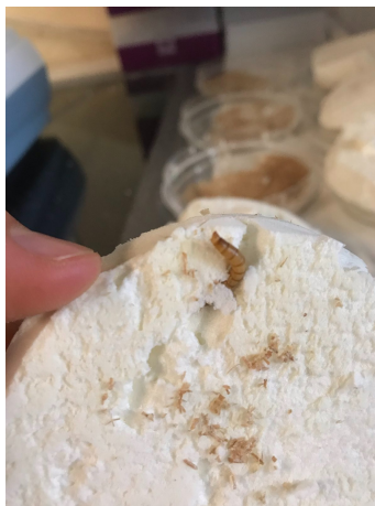
FIGURE 29 – Galerie creusée dans le PU par une larve de Tenebrio molitor
