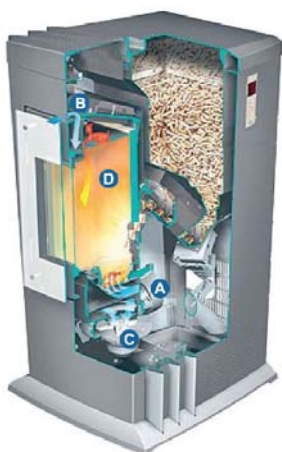
Figure 2.25 : Poêle à pellets : fonctionnement et emplacement
