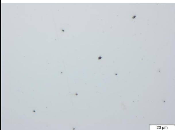
Figure IV-12.c : Zoom sur la matrice qui ne contient pas de précipité apparent en-dehors des inclusions
