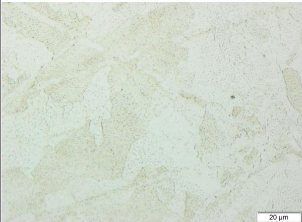
Figure IV-21.b : Présence de précipités dans la matrice et aux joints des grains
