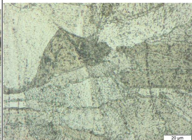
Figure IV-21.e : 50xbis ; progression des grains à travers les couches
