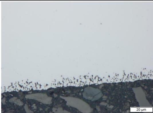
Figure IV-12.b : Oxydation (contamination) de la surface externe après traitement thermique
