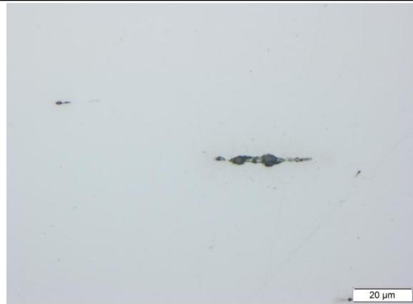
Figure IV-12.a : Vue générale et zoom sur les inclusions allongées et alignées suivant la direction principale du barreau. Absence de précipités apparents dans la matrice
