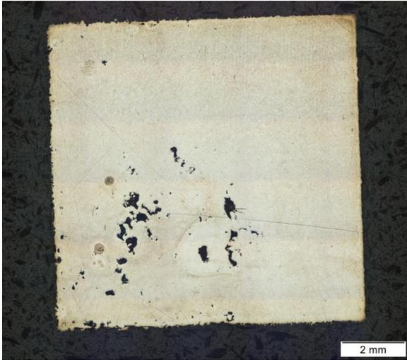
Figure IV-13.i : Vue générale à l'état attaqué du dessus de l'échantillon VR1 (brut de fabrication LBM). Présence de porosités grossières localisées majoritairement dans le coin inférieur gauche
