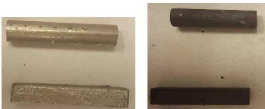
Figure III-10 : état des échantillons fabriqués par laser beam melting et extrudés avant et après traitement thermique
