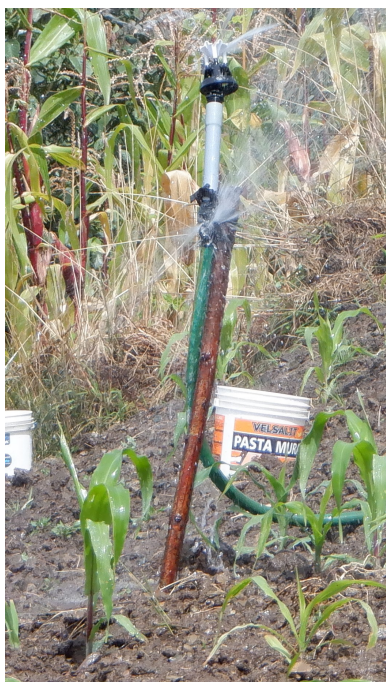
FIGURE 24 – Photo : asperseur décroché suite à une augmentation de pression trop importante.
