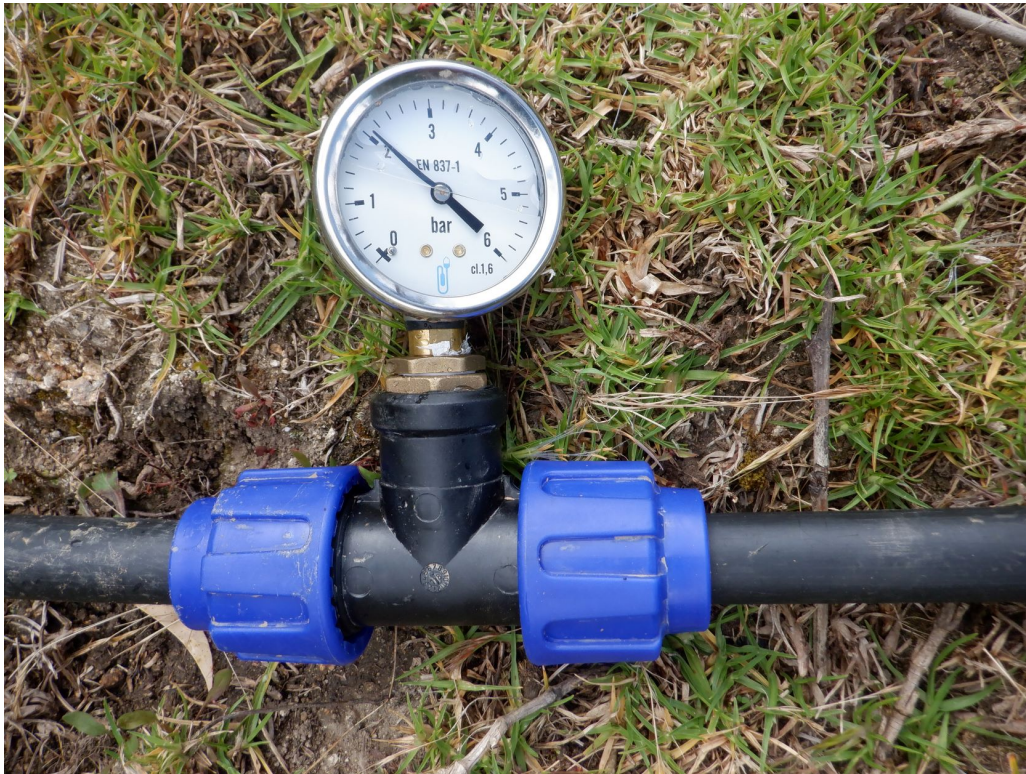
FIGURE 15 – Photo : réalisation de la mesure de pression sur le système d'irrigation par aspersion à l'aide d'un manomètre positionné au niveau d'un raccord.
