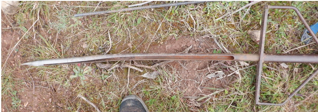
FIGURE 10 – Photo : tarière « fine » pliée après utilisation sur le terrain.
