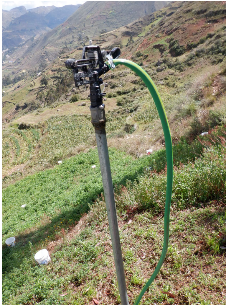
FIGURE 16 – Photo : réalisation de la mesure du débit sur un asperseur à l’aide d’un tuyau d’arrosage connecté à la bouche de sortie.
