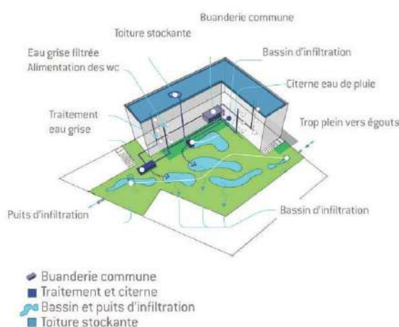
Figure 53 : Schéma de la gestion de l'eau d'un bâtiment (document de présentation du projet, CERAU)
