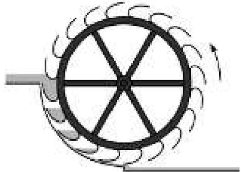
Fig 53 : Schéma d'une roue de poitrine
