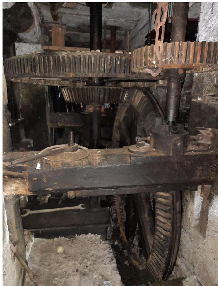
Fig 64 : Photographie personnelle du mécanisme d'une paire de meules du moulin Heine
