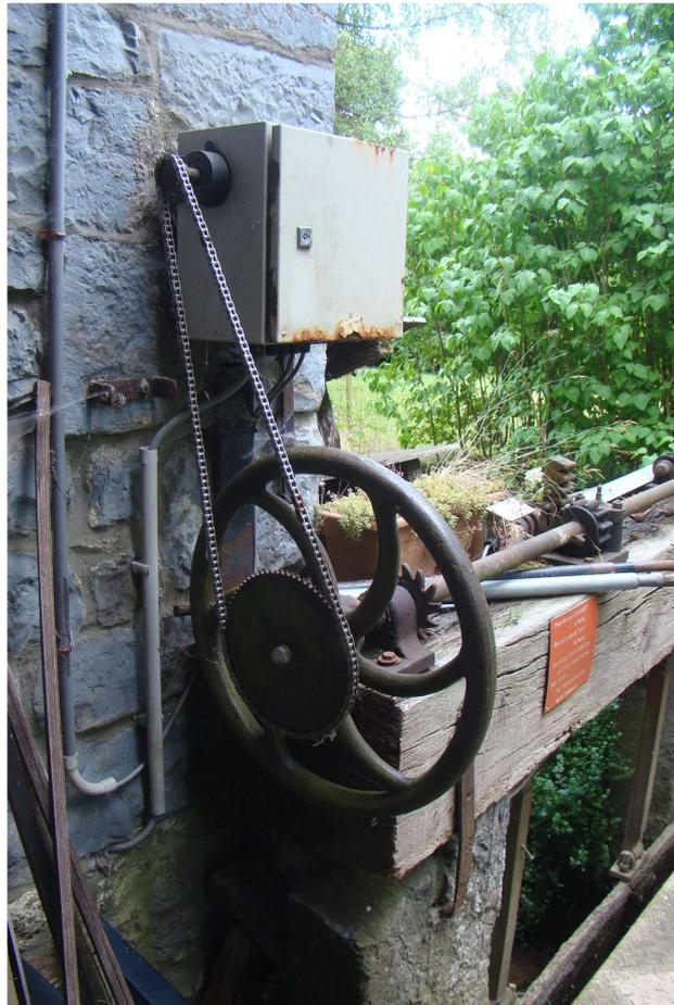
Fig 60 : Photographie personnelle du système de commande de la vanne
