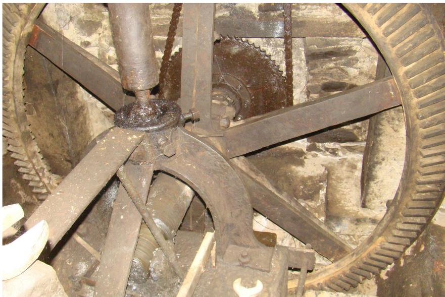
Fig 82 : Photographie personnelle mettant en évidence l'huile séchée au niveau des jointures ainsi que la rouille s'attaquant au niveau des éléments du mécanisme
