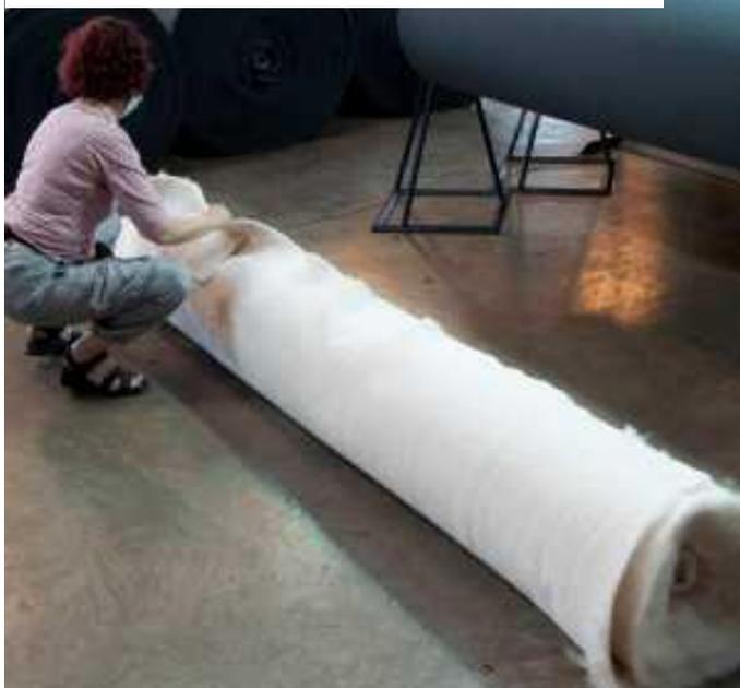
Pour ce faire, le matériau pelucheux va subir un processus d'aiguilletage (en anglais : « *needle punch process* »). L'objectif de ce processus est d'obtenir un tapis formé d'une multitude couches de fibres pelucheuses interconnectées, que Mme Hijosa appelle : Piñafelt.
