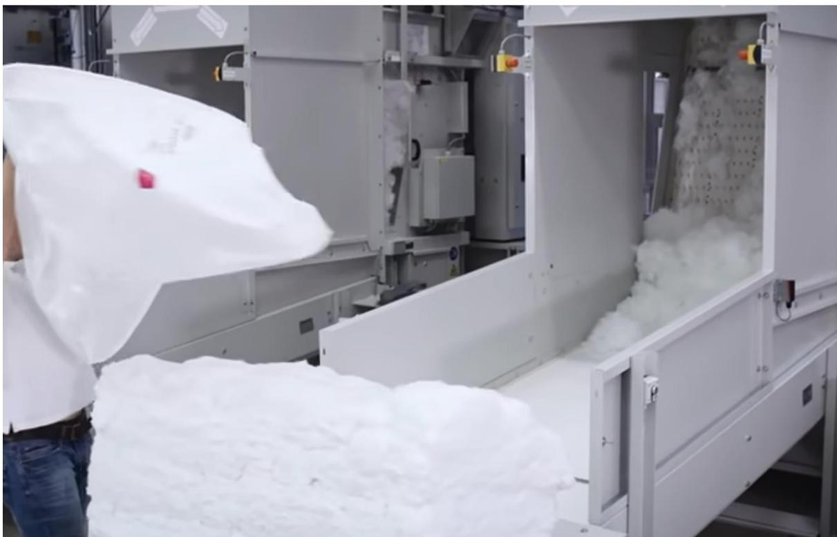
**Figure 39** : Fibres d'ananas purifiées et transformées en matériau pelucheux, avant le processus d'aiguilletage
