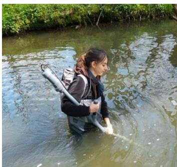
Figure 13 : Détection des anguilles européenne à l'aide du système RFID
