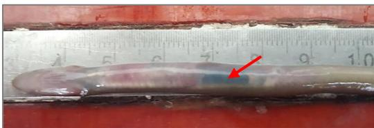
**Figure 11 :** Anguille marquée avec le système RFID
