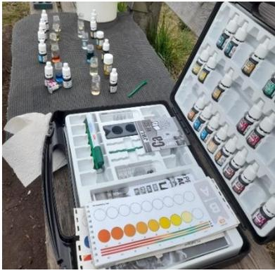
**Figure 10:** Photo de kit colorimétrique JBL Testlab
