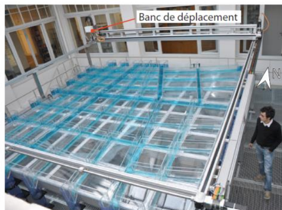
Figure 1 - Vue d'ensemble du pilote d'inondation (Araud, 2012)
