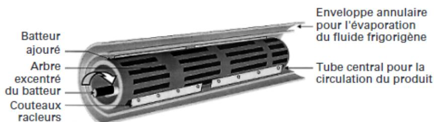
Figure 14: Coupe transversale d'un échangeur de chaleur à surface raclée (Boutonnier, 2001)
