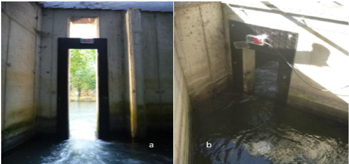
Figure 11 : (a) Vue amont de l'antenne RFID 1 – (b) Vue amont de l'antenne RFID 4
