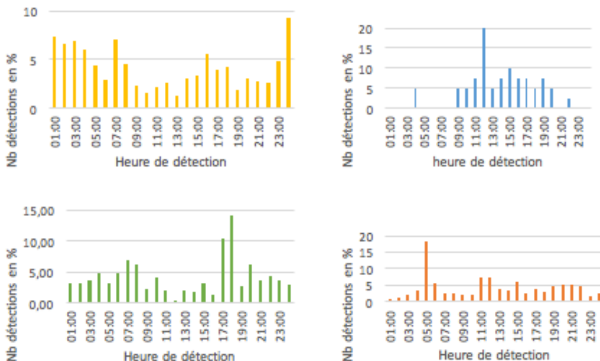
Figure 23 : Pourcentage de détections totales à l'antenne RFID 1 dans l'échelle à poissons par rapport au nombre de détections totales en fonction de l'heure pour chaque espèce (truite : jaune ; ombre : bleu ; barbeau : vert ; vandoise : orange).
