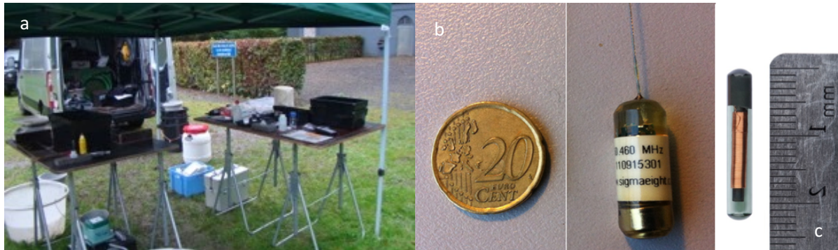
Figure 16 : (a) Matériel de mesures biométriques et marquage - (b) Emetteur Radio et (c) Transpondeur RFID
