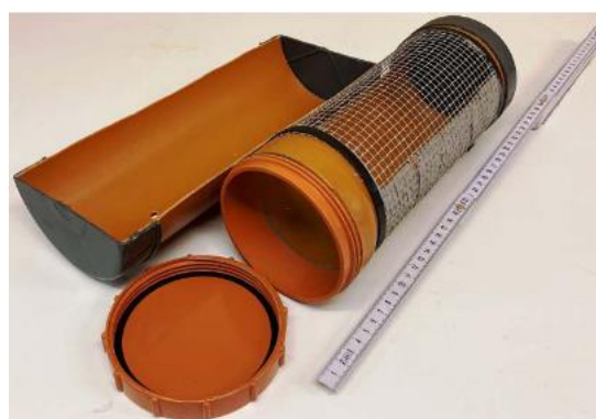
Figure 9 Piège à sédiments installé sur le site d'étude (Vaessen et al. , 2021)
