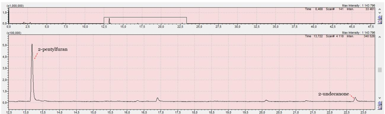
FIGURE 21 – Partie de chromatogramme obtenu au cours des prélèvements de billes d’alginate contenant du jus de pomme de terre, du 2-pentylfuran et du 2-undecanone (1 grammes de billes, 2 heures de prélèvement, 21 °C).
