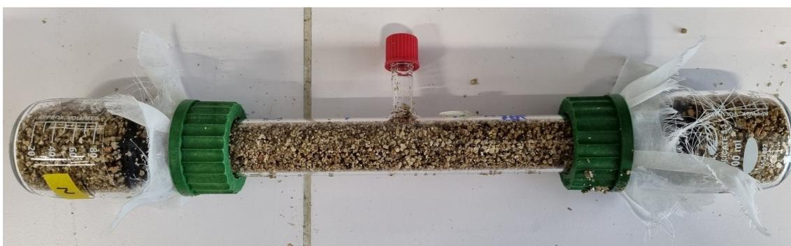
FIGURE 9 – Dispositif olfactométrique utilisé dans le cadre des tests comportementaux.
