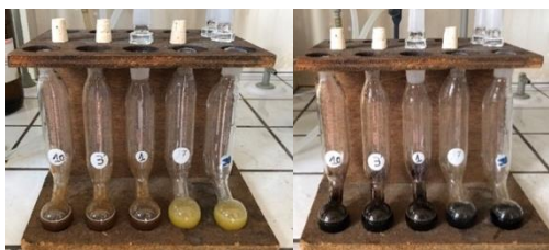
Figure 65 : Mojonnier avant (à droite) et après (à gauche) hydrolyse acide.
