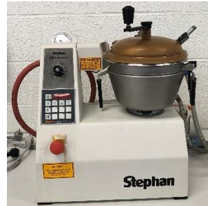
Figure 74 : Stephan UMC 5 électronique utilisé pour l'enrobage des snacks extrudés.
