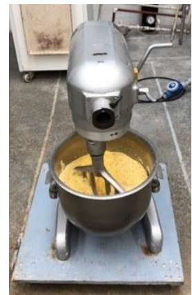
Figure 71 : Mélangeur Hobart avec une capacité de 5 kg.
