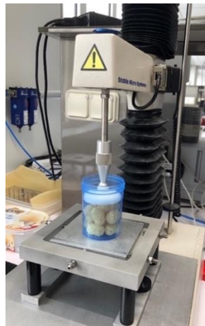
Figure 75 : Texturomètre SMS TA.XT2 avec la presse « HD/P50 50 mm DIA Cylinder Stainless » pour comprimer les snacks extrudés et analyser leur dureté et croustillance.
