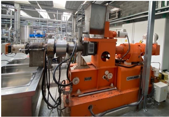
Figure 72 : Extrudeuse bavis (Creuset-Loire).
