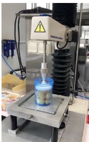
Figure 75 : Texturomètre SMS TA.XT2 avec la presse « HD/P50 50 mm DIA Cylinder Stainless ».
