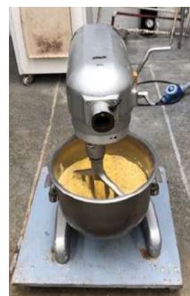
Figure 71 : Mélangeur Hobart avec une capacité de 5 kg.
