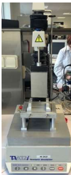
Figure 79 : Montage du texturomètre avec la lame Warner Bratzer Rectangular Natch Blade.
