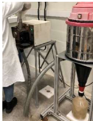
Figure 63 : broyage des drêches de brasserie avec le rotor à couteau Fritsch.
