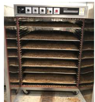
Figure 60 : Séchage des drêches de brasserie en étuve à 70°C.
