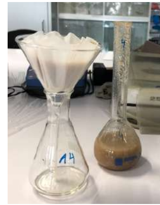
Figure 67 : Filtration avec 2 filtres Whatman 2V pour obtenir une solution qui contient l'amidon et qui peut être analysée au polarimètre.
