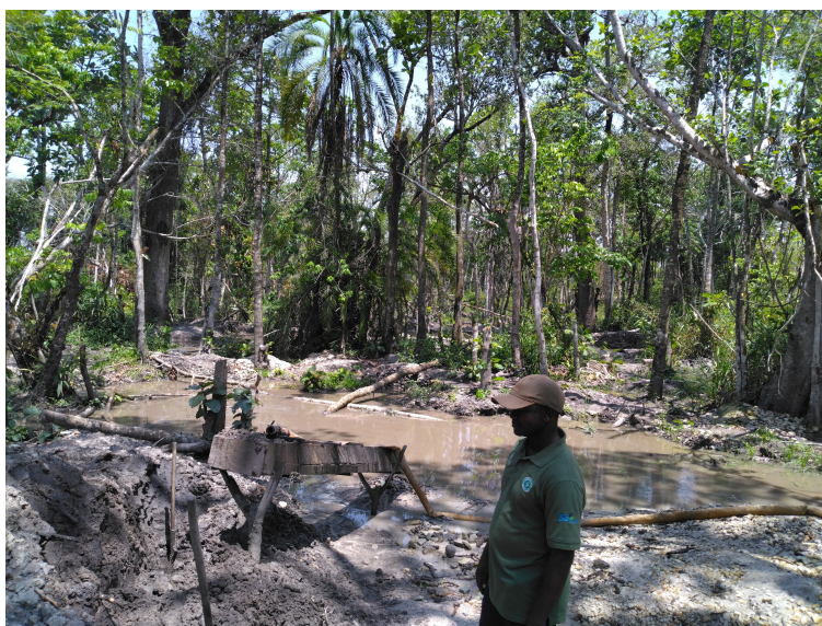
FIGURE 4 – Exemple d'un site d'orpaillage (Kwa sasa) avec pompe à essence et écluses bordées d'un «tapis de mineur»
