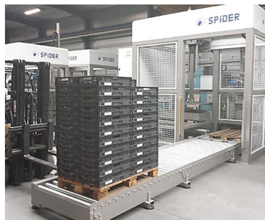
Figure 109 : Palettiseur pour bacs Spider® ( https://palletiser.be/fr/toepassing/culinor/ ).
