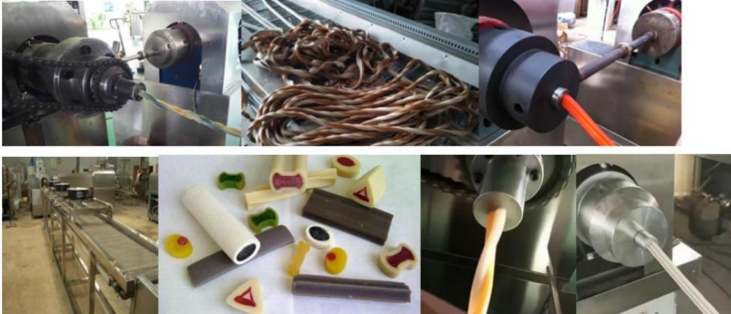
Figure 95 : Extrudeur de biscuits pour chiens (Loyal Industrial, s.d. 80-180kg Double Color per hour pet treat production line (1).pdf).
