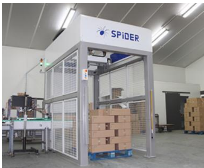
Figure 105 : Robot palettiseur Spider® ( https://palletiser.be/fr/ ).
