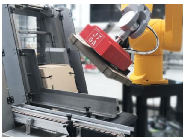
Figure 104 : Chargement automatique du magasin de cartons ( https://www.jyga.fr/encaisseuse-robotisee/encaisseuse-wrap-caisse-fermee ).
