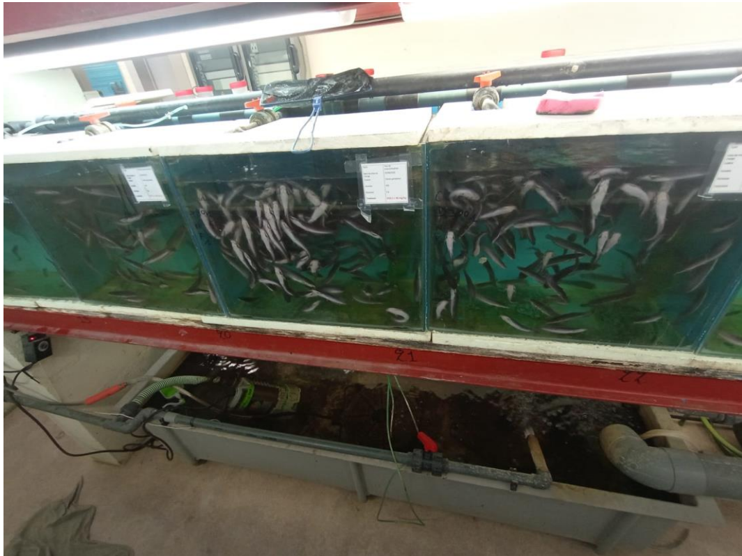
Figure 6 : Circuit expérimental de 15 aquariums de 50 litres alimentés en eau de puits chauffée dans un bac de charge à l'aide d'une résistance électrique
