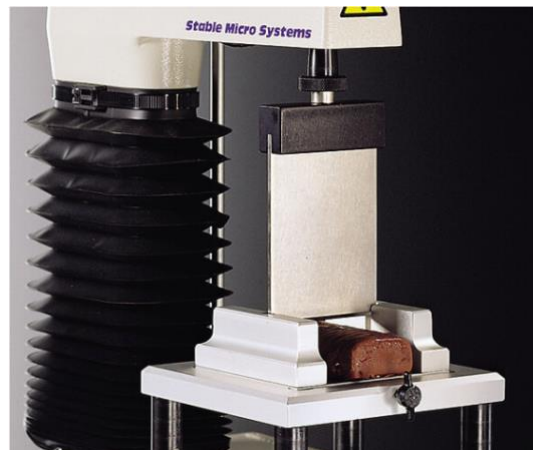
Figure 29 : Technique du tranchage à l'aide du « Knife blade set » ( https://www.stablemicrosystems.com/ConfectioneryTesting.html ).
