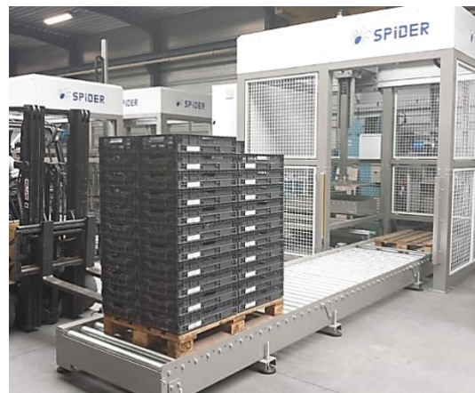
Figure 109 : Palettiseur pour bacs Spider® ( https://palletiser.be/fr/toepassing/culinor/ ).
