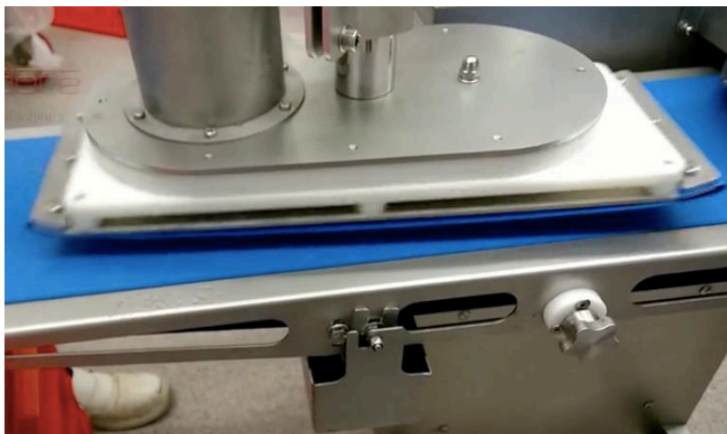
Figure 99 : Module de lissage du biscuit ( https://www.directindustry.fr/prod/sandore-srl/product-222134-2450812.html ).
