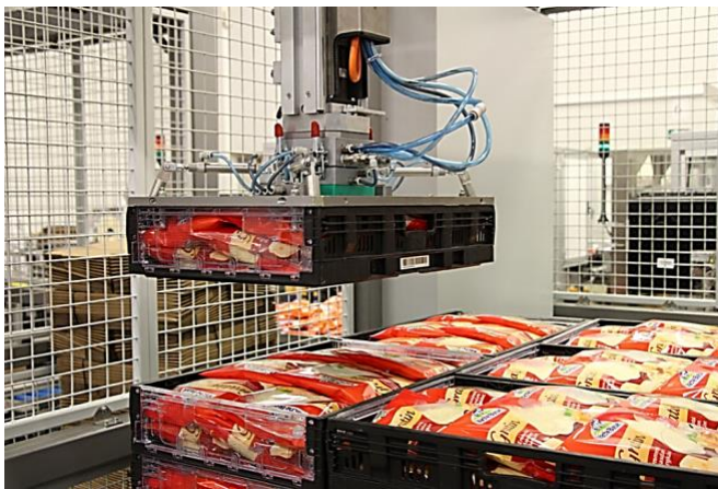
Figure 108 : Chargement des bacs sur la palette avec l'aide du préhenseur ( https://palletiser.be/fr/toepassing/vache-blueu/ ).
