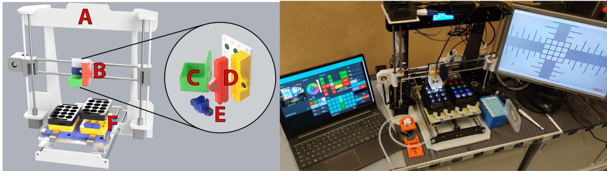
Figure 4 : Station d'imagerie multipoints automatisée. L'appareil s'appuie sur le châssis d'une imprimante 3D Anet A8 (A) dont l'extrudeur de plastique a été retiré et remplacé par un support magnétique imprimé en 3D en ABS (B) pour y installer une caméra numérique (C) et son objectif (E) ainsi qu'un support pour tip de micropipette (D). Le système est contrôlable à distance via le protocole MQTT.
