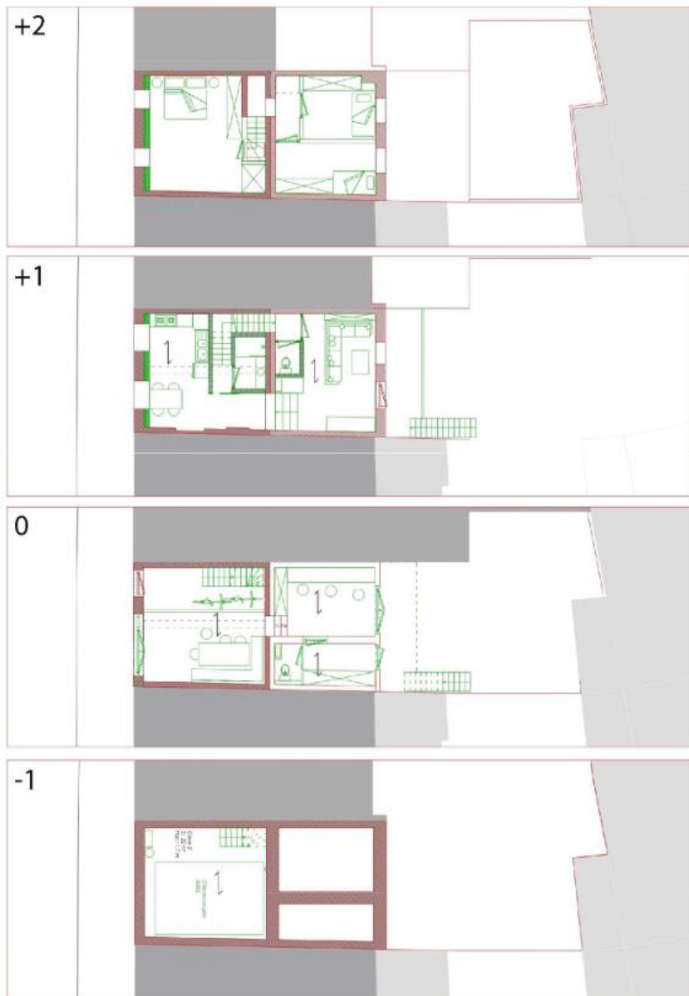
Figure 35 : Test en plans et coupe de l'aménagement d'une maison mitoyenne avec un logement aux étages et un espace pour la communauté de Pepinster au rez-de-chaussée – Groupe B, 2022
