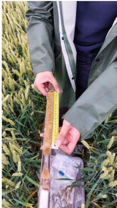
FIGURE 4 – Mesure de la longueur d'une carotte de sol
