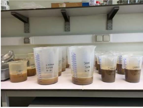
(a) Décantation des échantillons de sol dans une solution saturée en sel
