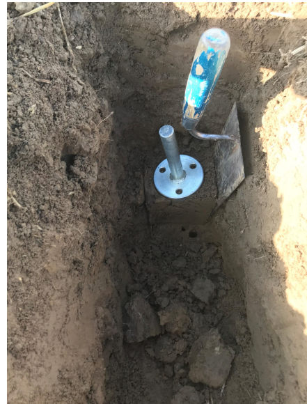
FIGURE 7.1 – Méthode de prélèvement des échantillons en structure conservée
