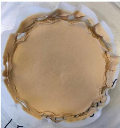
**Figure 53 : Précipités de  $\text{FePO}_4$  obtenus à l'Etape 1**
