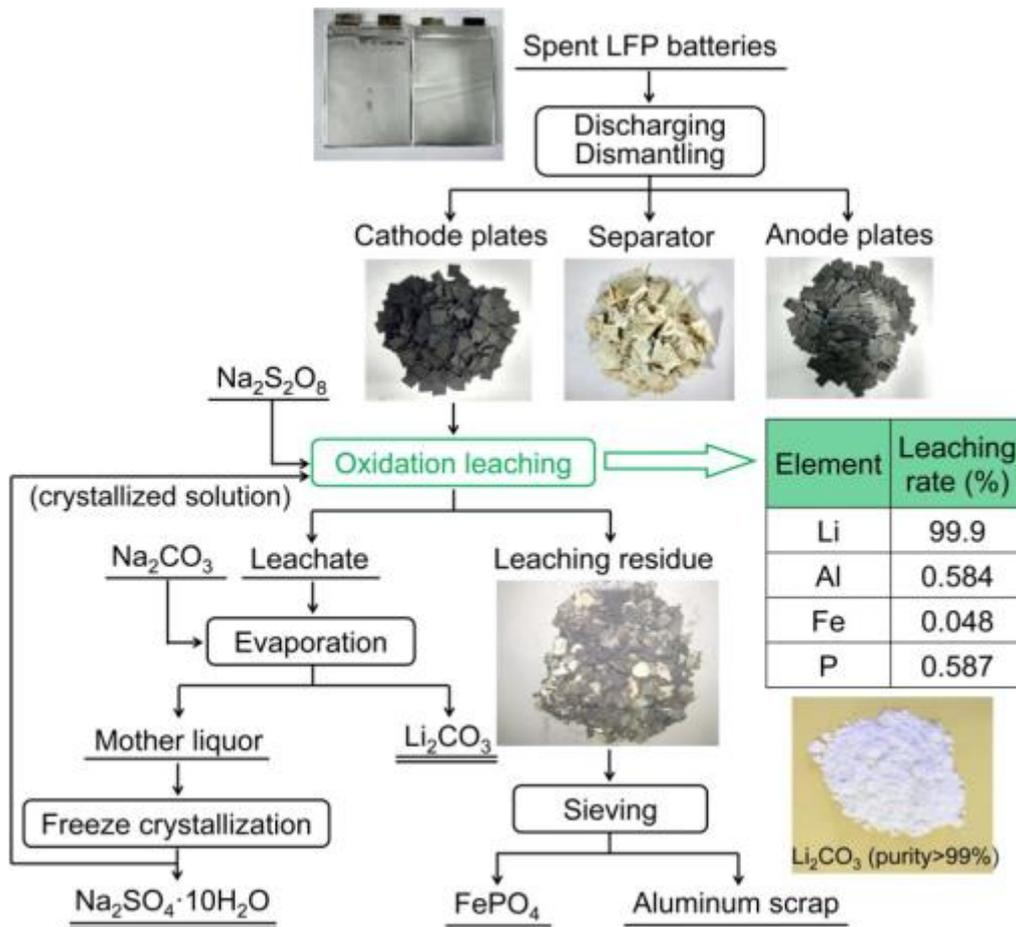
Annexe A-14 : Procédé de lixiviation sélective de Li à l'aide de  $\text{Na}_2\text{S}_2\text{O}_8$  (Zhang et al., 2019)
