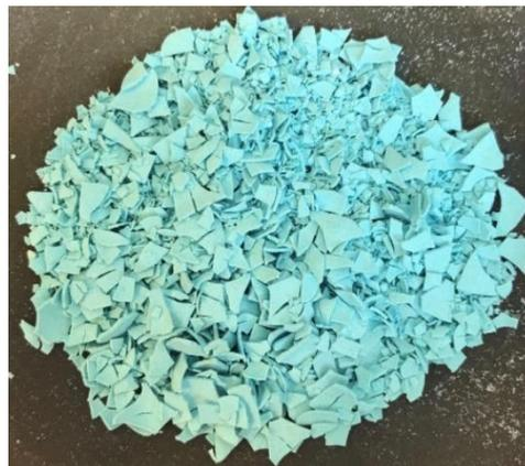
**Figure 54 : Précipités de  $\text{AlPO}_4$  et  $\text{Cu}_3(\text{PO}_4)_2$  obtenus à l'Etape 3**
