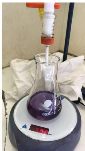
Figure 37 : Dosage du fer ferreux sous agitation magnétique continue
