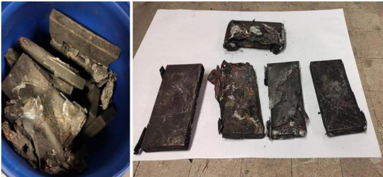
**Figure 15 : Cellules de batteries LFP en fin de vie après calcination (Celibashi, 2022)**
