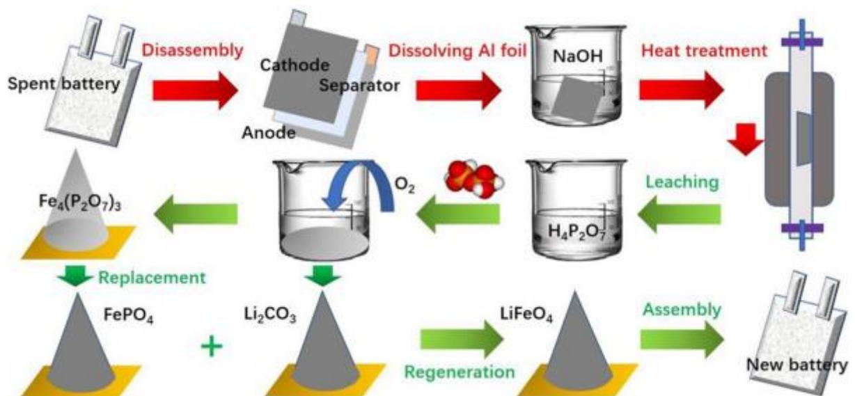
**Annexe A-7 : Schéma de récupération de Li, Fe et P à l'aide de H<sub>4</sub>P<sub>2</sub>O<sub>7</sub> (Liu, Yang et al., 2021)**
