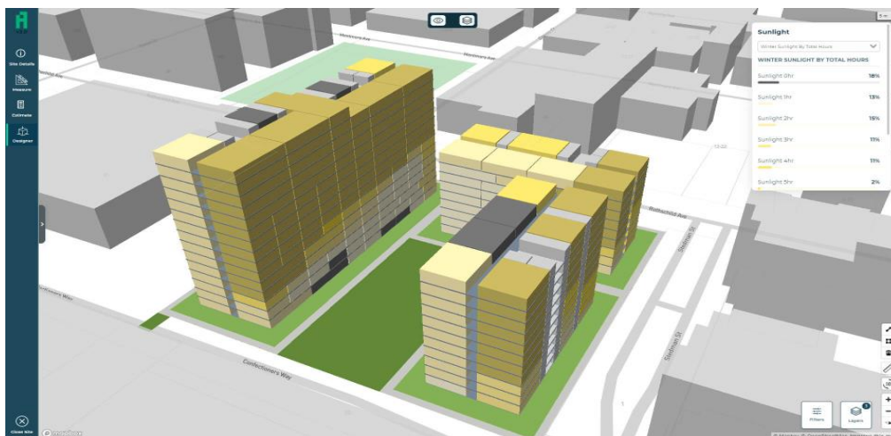
Figure 13. Interface de configuration d'Archistar pour la génération d'études sur la lumière, la ventilation et la séparation des bâtiments (source : https://www.archistar.ai/for-property-developers-legacy%20/ ).
