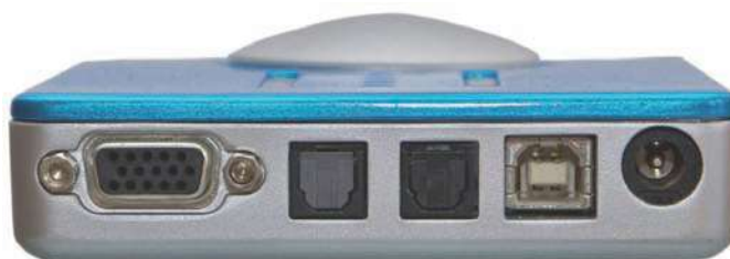
Sortie optique USB 2.0 Câble épanoui Entrée optique Alimentation
