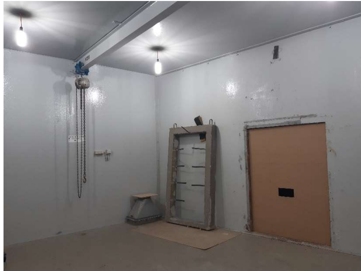
Figure 50 : Mesure de l'échantillons dans la petite chambre réverbérante
