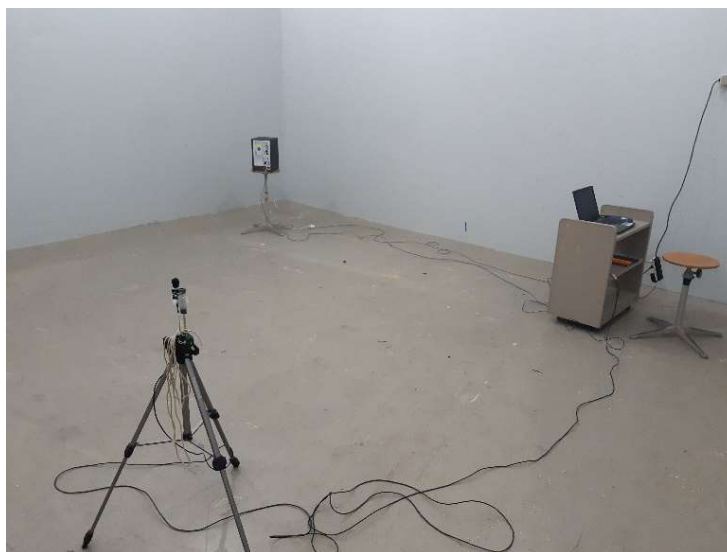
Figure 48 : Mesure de l'échantillon dans la grande chambre réverbérante
