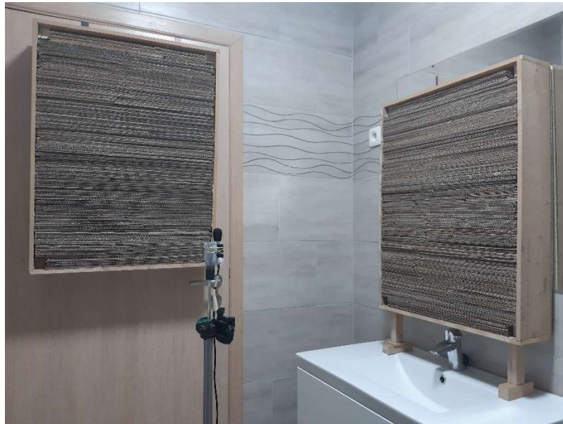
Figure 56 : Mesure du prototype en millefeuille de carton, (salle de bain, configuration 1, 04/04/2023)
