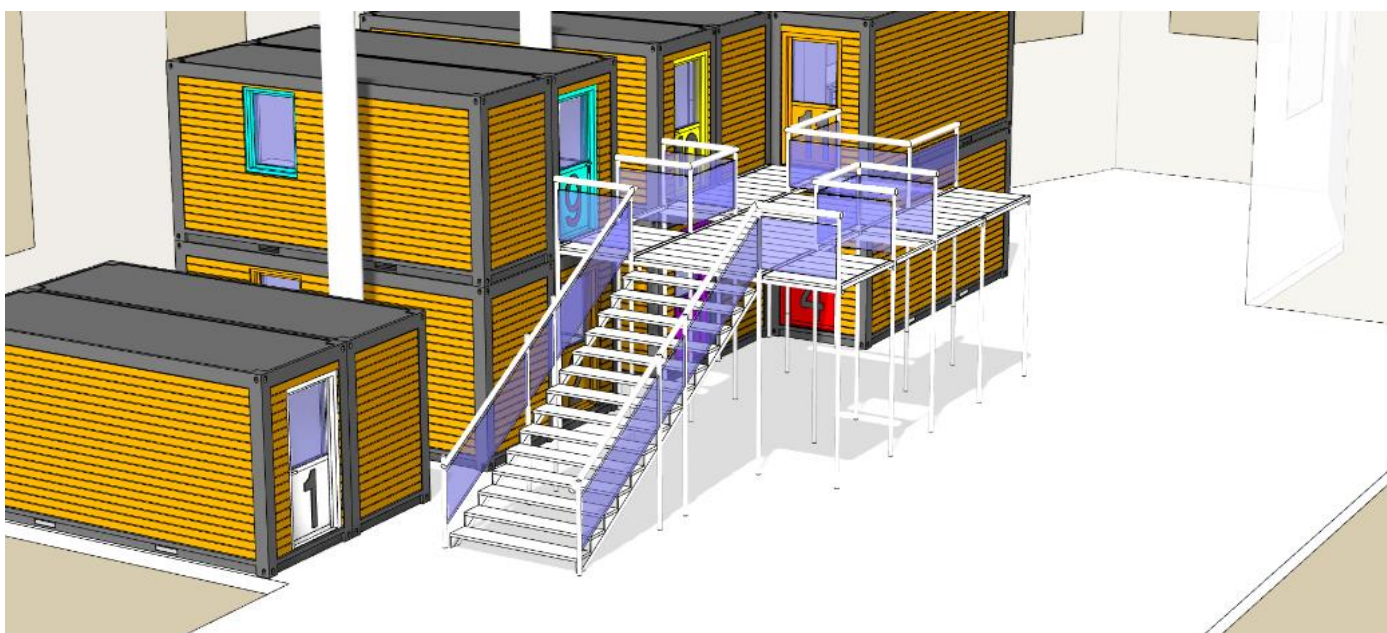
Figure 21 : Présentation de la structure d'échafaudage permettant d'accéder au premier niveau
